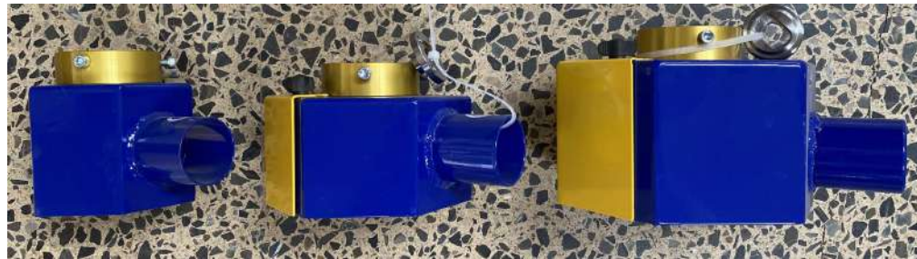
Carters de protection et aspiration des poussières acier hexagonal spécial bouchardage
